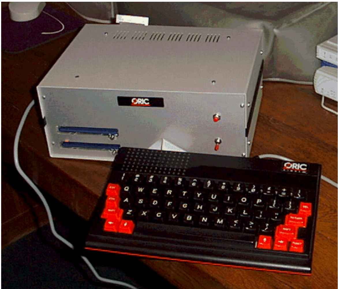
Photo 2 : l'ensemble précédent dans un unique coffret. Sur la face avant, les deux ouvertures des lecteurs de disquettes, l'interrupteur marche/arrêt et le bouton poussoir de Reset.
